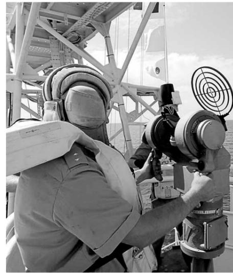
Управление артиллерийским огнем артиллерийской установки АК-630 от визирной колонки.
